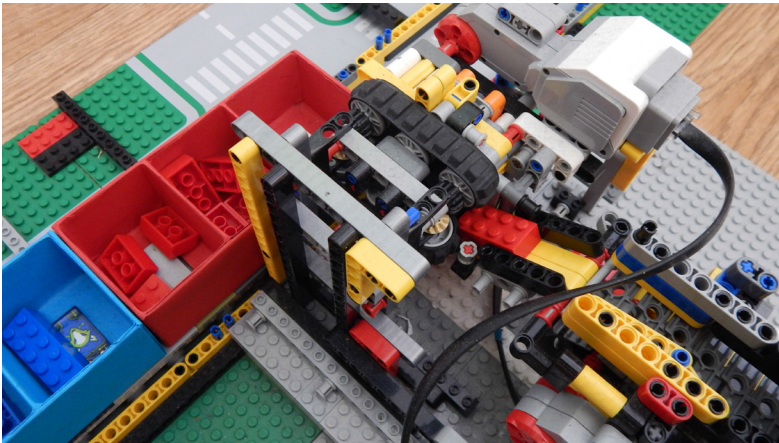
Abb.6 Maschinenteil der Größenmessung. Man sieht rechts das Laufband, das die LEGO-Steine von der Farbmessung zur Größenmessung transportiert. Danach rutschen die Steine über eine kleine Schräge zur Größenmessung. Im Hintergrund sieht man den Zug mit den Boxen der richtigen Farbe.
